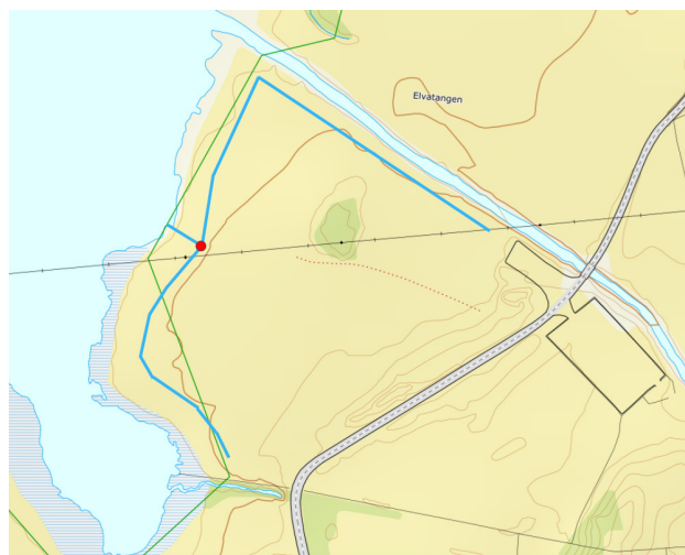
Figur 11: Skisse drensgrøft. Rødt punkt markerer oppsamlingskum for utslipp til resipient, mens blå linje viser drensledningene som samler opp sigevannet (COWI).
