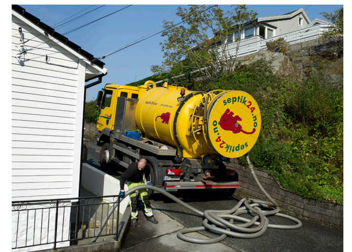
Septiktømming der husstanden ikke er tilkoblet kommunalt avløpsnett. (Foto, Helge Skodvin)
